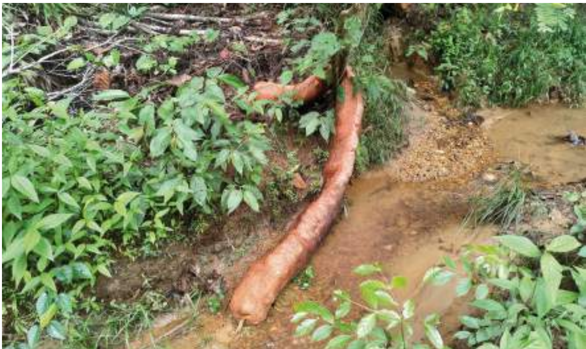
FIGURA 8.16. Barrera oleofílica abandonada. Quebrada receptora del drenaje de la Batería 9. Yacimiento Pavayacu
