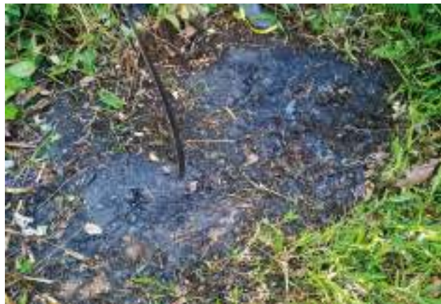
FIGURA 8.53. Suelo no saturado contaminado con petróleo degradado en el borde norte de la Bateria 3. Yacimiento Yanayacu
