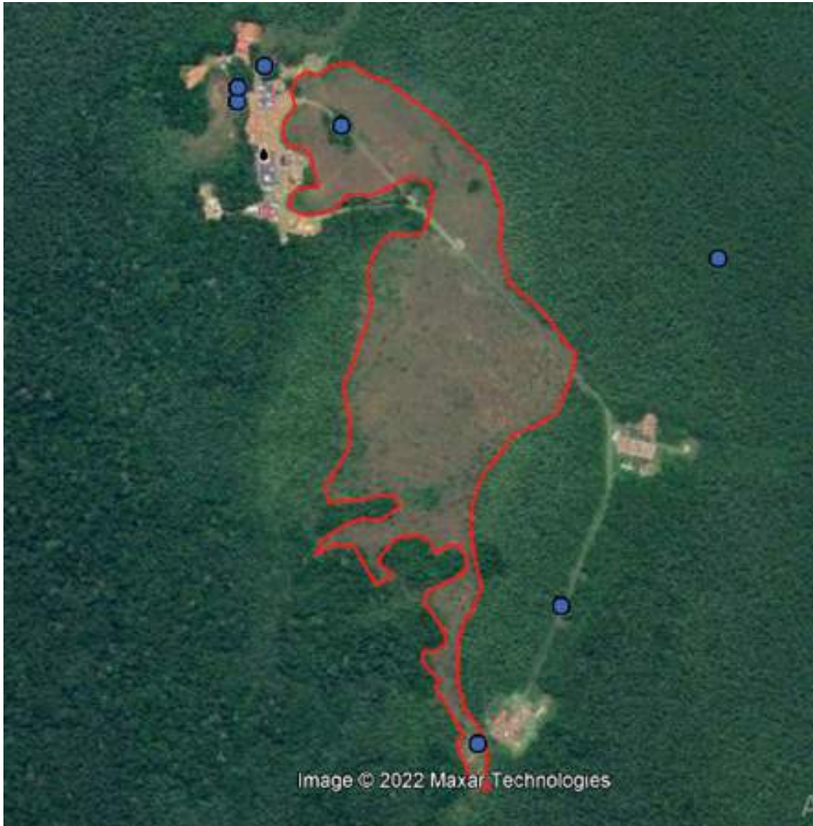
FIGURA 8.13. Vista aérea de la Batería 3 en el yacimiento Yanayacu y del área afectada por la descarga de aguas de producción (delimitada con borde rojo en la foto). La superficie aproximada de la afectación es de 60 ha
